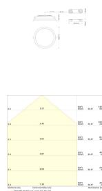
**Caractéristiques Ledvance Spot Encastrable LED Comfort Opale Blanc 42W/36W/30W 5000lm/4200lm/3600lm 100D - 930-940 CCT | Diamètre 200mm - IP44 - Meilleur Rendu De Couleur - Dali Dimmable**
