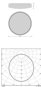
**Caractéristiques Ledvance Hublot LED Ronde Blanc 12.5-19.5W 1360-2230lm - 830-840 CCT | 312mm - IP65 - 3H Éclairage**
