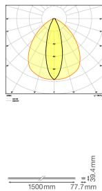
**Caractéristiques Ledvance LED Rail de fixation suspendu Trusys Flex Claire 50W 8600lm 30D - 840 Blanc Froid | Éclairage de secours 3 heures**
