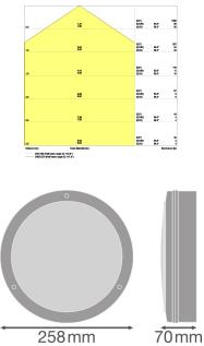
**Caractéristiques Ledvance Surface Bulkhead 250 10W 840 800lm Noir IP65 | Éclairage de secours 3H avec détecteur**
