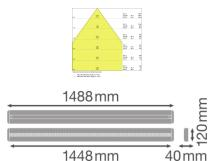
Caractéristiques Ledvance LED Suspension Luminaire Linear IndiviLED 25W
