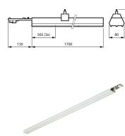
Technische Daten Philips LED Tragschiene Coreline LL217X 79W 12000lm 67x67D - 840 | 1700mm - 5-polig
