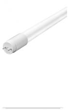
**Technische Daten LED Röhre T8 Extreme (EM/Mains) High Output 16.5W 2650lm - 830 | 150cm - Ersatz Für 58W**
