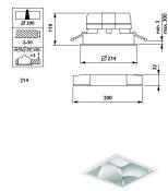
Technische Daten Philips LED Deckenstrahler LuxSpace Quadrat DN572B VLC-E 10.3W 1350lm 80D - 830 | 214mm - Dimmbar - Aluminium Reflektor - Dali Dimmbar
