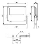
**Technische Daten Philips LED-Scheinwerfer Coreline BVP125 Grau 98W 12000lm 69x25D - 740 | IP66 - Asymmetrisch**
