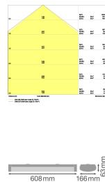
**Technische Daten Ledvance LED Feuchtraumleuchte 18W 2340lm - 830 | 60cm - Dali Dimmbar**
