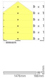
**Technische Daten Ledvance LED Feuchtraumleuchte 45W 6165lm - 840 | 150cm**
