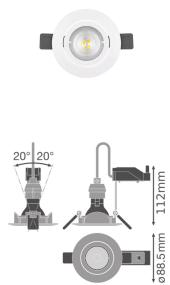
**Technische Daten Ledvance LED-Spot Kit schwenkbar GU10 PAR16 8.3W 520lm 36D - 940 | Höchste Farbwiedergabe - Dimmbar - Ersatz für 65W**
