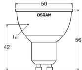
**Technische Daten Osram Parathom Retrofit Led-Spot GU10 PAR16 2,9W 250lm 120D - 827 Extra Warmweiß | RGBW - Dimmbar - Fernsteuerung - Ersatz Für 25W**
