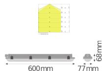
Technische Daten Ledvance LED Feuchtraumleuchte Feuchtigkeitsdicht Value 18W 2160lm - 840 | 60cm
